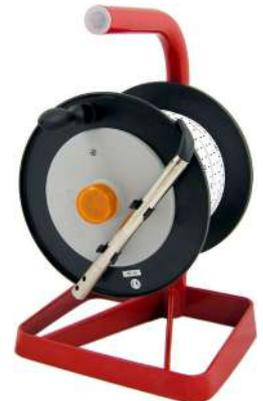
Sonda de contacto tipo KLL 15-1000 m con marco de soporte
